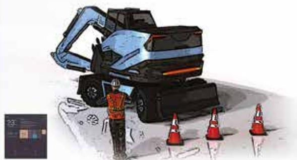
Per migliorare ulteriormente la manovrabilità e il comfort dell'operatore, è stato implementato un sistema di controllo esterno. Questo sistema consente all'operatore di controllare l'escavatore anche dall'esterno della cabina.
