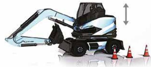
Introdotta una cabina regolabile in altezza, che consente all'operatore di alzare e abbassare la cabina per ottenere una migliore visuale sulla zona di lavoro. Ciò permette all'operatore di avere una visione chiara dei movimenti dell'escavatore e di lavorare in modo più preciso e sicuro.
